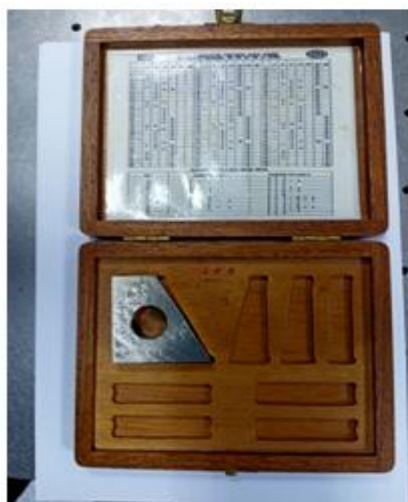
Слика 2. Еталон - гранична мера угла са угловима од 30°, 60° и 90°.
